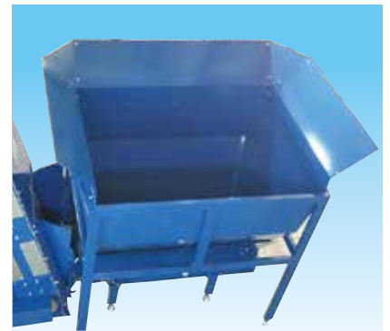
土漏れ防止コの字フェンス
