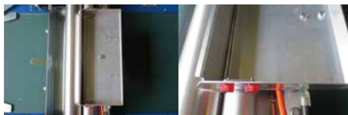
微細粒種子用シードトレイ(攪拌ロール式)
