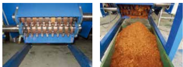
2次粉碎装置で砕かれたココヤシピートモスが排出されます。
