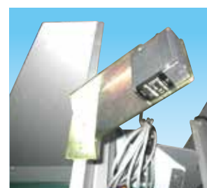
満杯感知制御センサー ポットिंगマシンと直結する場合に培土の減量検知を行い自動排出制御が出来ます。
