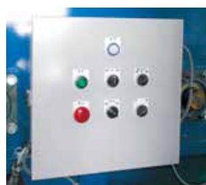
ベルトコンベア連動 自動排出制御盤 排出コンベアやポットिंगマシンとの連動制御させることにより、作業効率を高めます。
