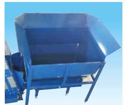
土漏れ防止コの字フェンス
