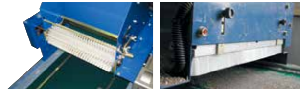
〈オプション〉とも土ブラシユニット 〈オプション〉出口ならしブラシ
