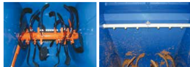
ホッパー内で散水と1次粉碎を行います。
