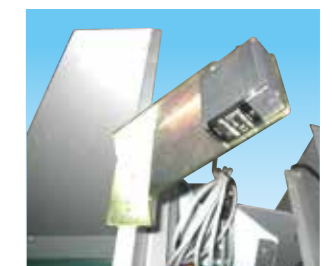
満杯感知制御センサー ポットングマシンと直結する場合に培土の減量検知を行い自動排出制御が出来ます。
