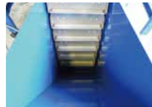
昇降機はステンレス製の バケットを採用
