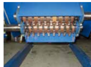
2次粉碎装置で砕かれたココヤシピートモスが排出されます。
