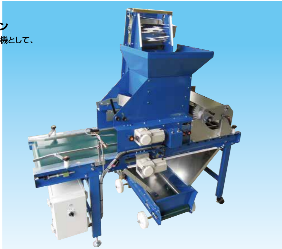
昇降機はステンレス製の バケットを採用
