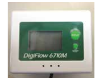
灌水メーター 散水量を積算流量計で確認する事が出来ます。
